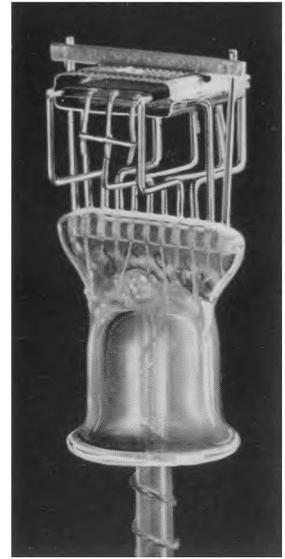
Innenkonstruktion der Röhre B 228.
