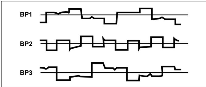
Figure 24. Backplane Waveforms
